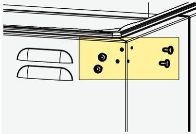
3. Plaats de montagebeugel op het deksel en bevestig deze met de schroeven.
