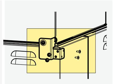
4. Draai de schroeven vast en controleer of het deksel goed past.
