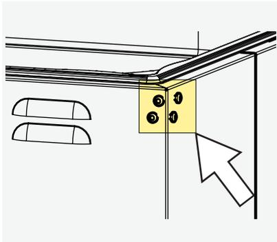
2. Verwijder de schroeven en leg deze terzijde.
