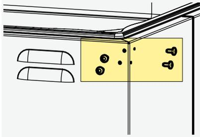
3. Befestigungswinkel des Deckels anlegen und mit den Schrauben fixieren.
