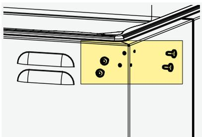
3. Fissare la staffa di montaggio al coperchio e bloccarla in posizione con le viti.
