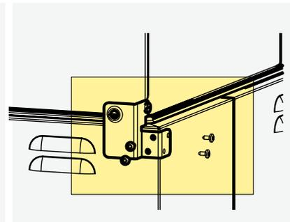
4. Serrez les vis et vérifiez que le couvercle est bien en place.
